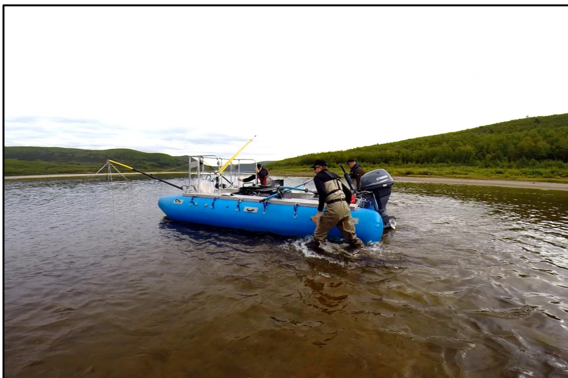
Bilde 4. Catacraft-båten som ble benyttet under det elektriske båtfisket flyter høyt i vannet og kan operere i vanddybder ned mot 15-20 cm. Noen steder var det likevel nødvendig med håndkraft for å dra båten forbi spesielt grunne elveparti. Foto: Anders Foldvik.
