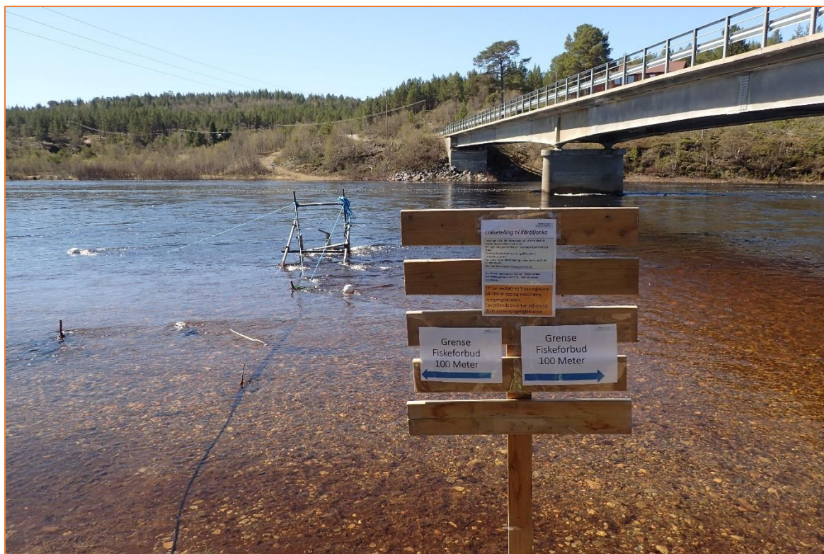
Bilde: Sommeren 2017 ble lakseoppgangen til øvre del av Kárášjohka overvåket med sonar. I første del av sommeren (juni) stod sonaren på oversida av Bieskkenjárgbrua som vist på bilde. I juli og august var sonaren rigget opp på Heastanjárga noen hundre meter på nedsida av brua. Høy og varierende vannstand gjennom sesongen gjorde oppgaven vanskelig, og det var mye større usikkerhet i tellingene enn det ville vært et normalår (foto: Narve S. Johansen).
