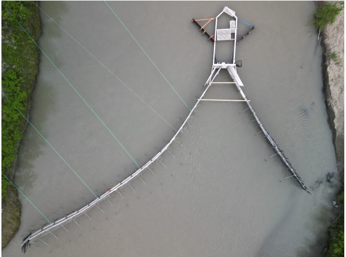
Bildet 2 viser spilefellen i sin helhet med stømforsterkende anlegg med kryssfinérplater på både innsiden og utsiden av fangstkammeret, det V-formede ledegjerdet, utvandringspassasjer på hver side og forsterkninger mot land. Bildet ble tatt rett etter åpning av fellen, etter den var stengt ifm. leirras.
